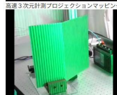
高速3次元計測プロジェクションマッピングを利用した微小変位分布の実物上への表示
